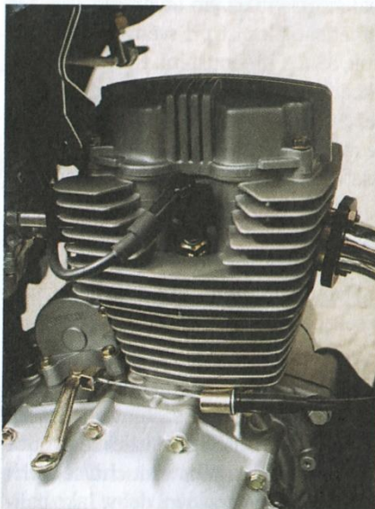
Obr. 1.59 Chlazení motoru motocyklu vzduchem.
